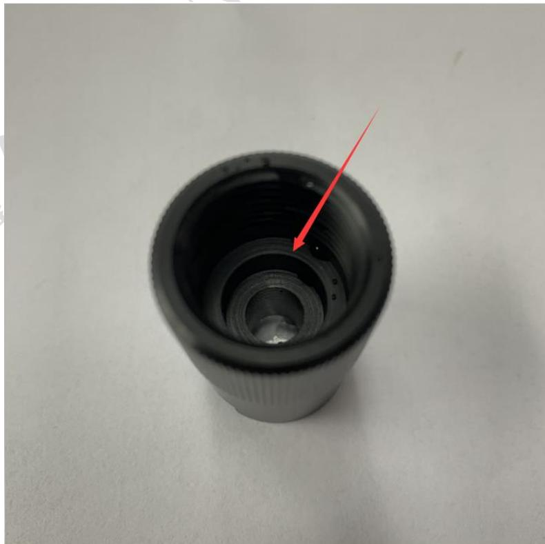
5,轻轻晃动溶氧膜套，确保电解液中没有气泡后旋紧溶氧膜套。
